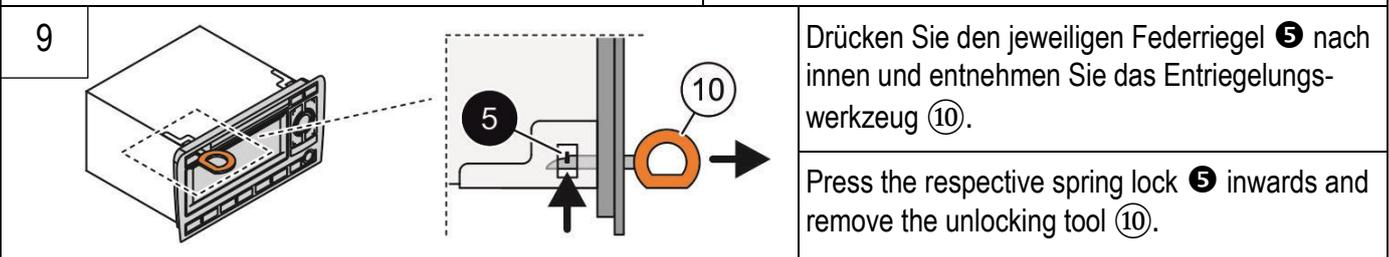
Drücken Sie den jeweiligen Federriegel (5) nach innen und entnehmen Sie das Entriegelungswerkzeug (10).
