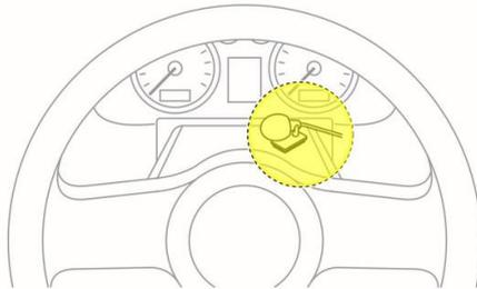
Wählen Sie eine geeignete Position für das Mikrophon. Wir empfehlen die im Bild dargestellte Position.
