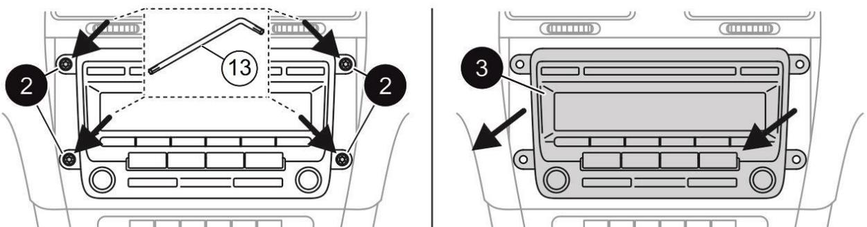
Lösen Sie die Befestigungsschrauben **2** und ziehen Sie das Radio **3** aus dem Montageschacht. Achten Sie darauf, keine Beschädigungen zu verursachen.
