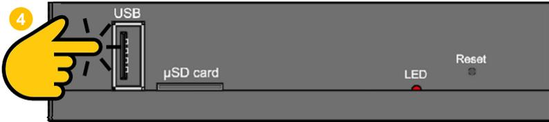
Erstellen Sie zunächst ein Verzeichnis auf dem USB-Laufwerk mit dem Namen LogoDB. Kopieren Sie dann die konvertierten Bilddateien im .PNJ-Format in dieses Verzeichnis. Schließen Sie den so vorbereiteten USB-Stick an den USB-Anschluss 4 des Interface an.
